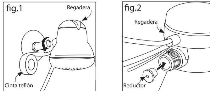
Antes de realizar la instalación eléctrica, abra la llave y deje correr el agua por la regadera hasta formar un chorro de agua continuo EVITANDO QUEMAR LA RESISTENCIA.
