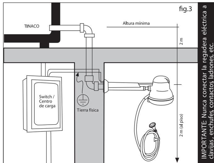
Utilice cable calibre 10 AWG para la instalación con la red eléctrica.
