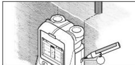
Para marcar exactamente un objeto en la pared desplace el aparato de medición hacia la izquierda o derecha hasta conseguir que el objeto localizado coincida con uno de los bordes laterales. Si, por ejemplo, el objeto localizado se muestra en el display **16** coincidiendo con la línea discontinua derecha **g**, Ud. puede marcar exactamente su posición con la muesca de marcación **3**.
