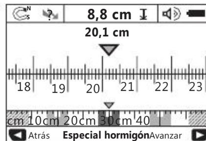
En el ejemplo del modo con la escala métrica se muestra la misma situación que en la figura D: tres barras de hierro colocadas a igual distancia. En el modo con la escala métrica puede determinarse la separación entre los centros de los objetos detectados.
