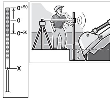
Η σταδία **31** φέρει στο επάνω τμήμα της μια σχετική ( $\pm 50$  cm) κλίμακα μέτρησης. Το ύψος μηδέν της κλίμακας αυτής μπορεί να προεπιλεγεί κάτω, στο κινητό τμήμα της σταδίας. Μ' αυτόν τον τρόπο μπορείτε να διαπιστώσετε τυχόν αποκλίσεις από το ονομαστικό ύψος.
