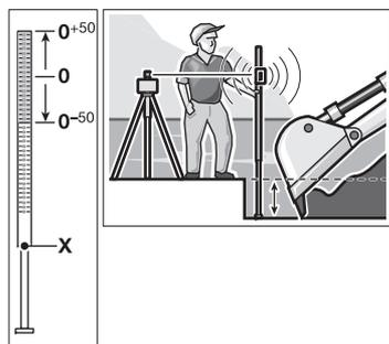
Une graduation relative ( $\pm 50$  cm) est sur la mire graduée **31**. Sa hauteur zéro peut être présélectionnée sur la rallonge. Ceci permet de lire directement des écarts de la hauteur souhaitée.
