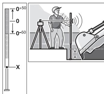
Oppe på nivellerstangen **31** befinner det seg en relativ måleskala ( $\pm 50$  cm). Nullhøyden kan du forhåndsinnstille nede på uttrekket. Slik kan avvik avleses direkte fra beregnet høyde.
