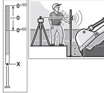
Ölçme latasının **31** üst tarafına bir nispi ölçme skalası ( $\pm 50$  cm) çizilmiştir. Bu skalanın sıfır yüksekliğini alttaki çıkıntıda önceden seçebilirsiniz. Bu sayede gerekli yükseklikten olan sapmaları doğrudan okuyabilirsiniz.
