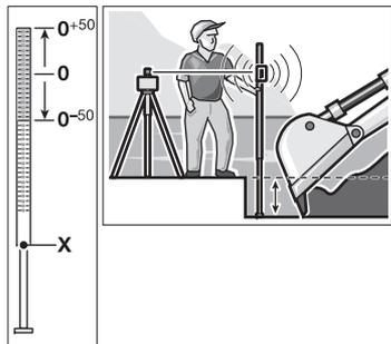
No lado superior da régua de medição **31** encontra-se uma escala de medidas relativa ( $\pm 50$  cm). A altura zero pode ser pré-selecionada em baixo, na corredeira. Assim poderá ler diretamente as divergências em relação à altura nominal.
