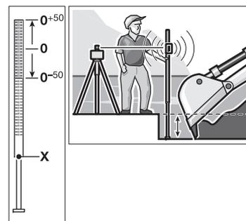
På målepladen **31** ses foroven en relativ måleskala ( $\pm 50$  cm). Dennes nulhøjde kan du indstille foruden på udtrækket. Dermed kan afvigelser fra den indstillede højde aflæses direkte.
