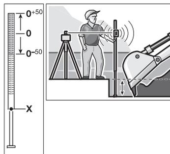
В верхней части дальномерной рейки 31 нанесена относительная измерительная шкала ( $\pm 50 \text{ см}$ ). Нуль задается внизу на выдвижной части. Благодаря этому можно сразу видеть отклонения от заданной высоты.
