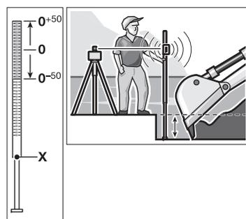
Na měřicí latě **31** je nahoře nanášena relativní odměřovací stupnice ( $\pm 50$  cm). Tou můžete předvolit dole na výsuvu nulovou výšku. Tím lze přímo odečíst odchylky od požadované výšky.
