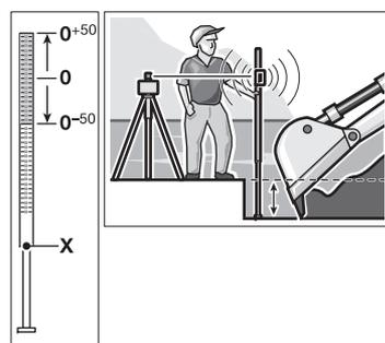
La escala de nivelación **31** lleva en su parte superior una escala relativa ( $\pm 50$  cm). El nivel de altura de su punto de cero puede ajustarse en la base extraíble. De esta manera es posible determinar directamente las desviaciones respecto a la altura nominal.
