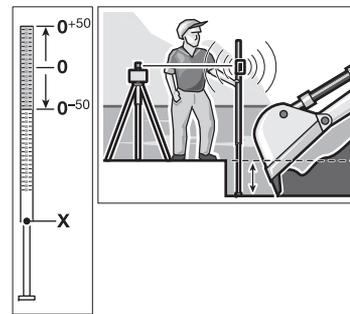
У верхній частині вимірювальної рейки 31 нанесена відносна вимірювальна шкала ( $\pm 50 \text{ см}$ ). Нуль задається внизу на витяжній частині. Це дозволяє зразу бачити відхилення від заданої висоти.
