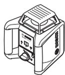
Postavite mjerni alat na stabilnu podlogu ili ga montirajte na stativ **30**.
