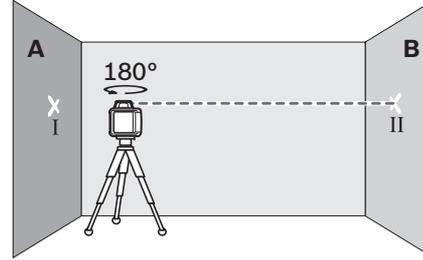
– Ölçme cihazını 180° çevirin, nivelman yapmasını bekleyin ve karşı taraftaki B duvarındaki lazer ışının ortasını işaretleyin (Nokta II).
