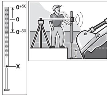
U góry łąty mierniczej **31** naniesiona jest relatywna skala ( $\pm 50$  cm). Jej wysokość zerową można wybrać wstępnie u dołu. W ten sposób można w sposób bezpośredni odczytać odchylenia od wysokości zadanej.
