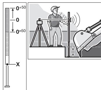
Sulla parte superiore dell'asta metrica **31** è applicata una scala di misurazione relativa ( $\pm 50$  cm). L'altezza zero della stessa può essere preselezionata nella parte inferiore sull'asta metrica telescopica. In questo modo è possibile rilevare direttamente divergenze dall'altezza nominale.
