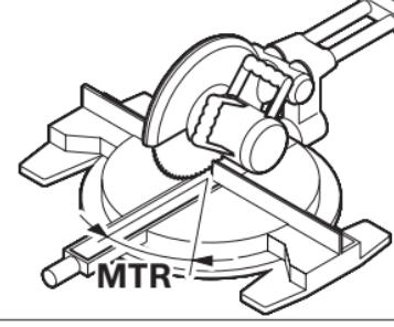
Presione el botón **14**. El ángulo de inglete horizontal calculado “**MTR**”, que se tiene que ajustar en la sierra troceadora e ingleteadora, y el indicador “**MTR**” se mostrarán en la pantalla.
