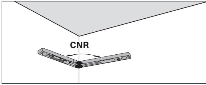
Pour mesurer l'angle de coin, placez le pied pliant et le pied de la base à plat contre les murs et lisez l'angle de coin mesuré ou paramétrez un angle de coin connu sur le mesureur d'angle.
