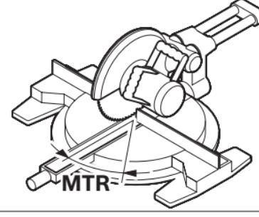
Appuyez sur le bouton **14**. L'angle d'onglet horizontal calculé « **MTR** », qui doit être paramétré sur la scie à déchiqueter/scie à onglet, et l'indicateur « **MTR** » seront affichés sur l'écran.
