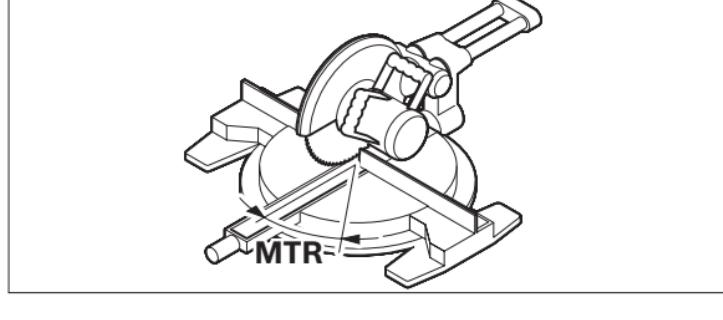
Presione de nuevo el botón **15. “MTR”** y el ángulo de inglete calculado para la sierra troceadora e ingleteadora se indicarán en la pantalla.
