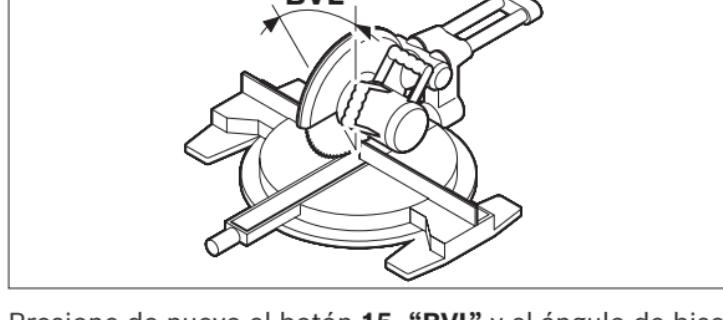
Presione de nuevo el botón **15. “BVL”** y el ángulo de bisel calculado para la sierra troceadora e ingleteadora se indicarán en la pantalla.
