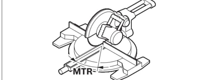
Appuyez à nouveau sur le bouton **15. « MTR »** et l'angle d'onglet calculé pour la scie à déchiqueter/scie à onglet sont indiqués sur l'écran d'affichage.
