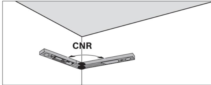
Para medir el ángulo de esquina, coloque la pata desplegable y la pata de la base en posición plana contra las paredes y lea el ángulo de esquina medido o ajuste un ángulo de esquina conocido en el localizador de ángulos.
