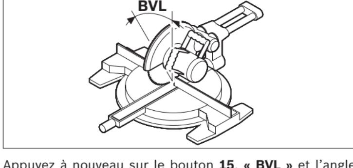
Appuyez à nouveau sur le bouton **15. « BVL »** et l'angle d'onglet calculé pour la scie à déchiqueter/scie à onglet sont indiqués sur l'écran d'affichage.
