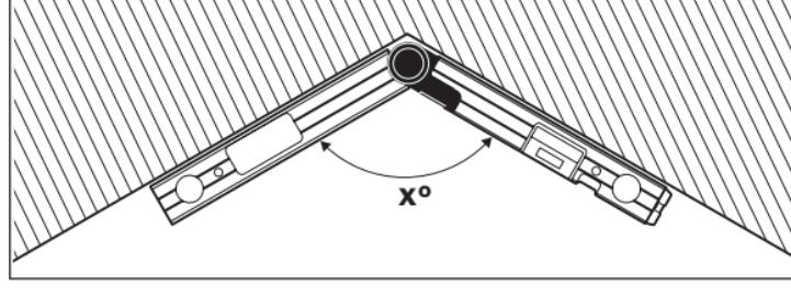
Cuando las piezas de trabajo se vayan a encajar en una esquina (p. ej., para molduras de piso), mida el ángulo de esquina **x°** aplicando la pata desplegable y la pata de la base. Para ángulos determinados (p. ej., marcos de cuadros), abra la pata desplegable y la pata de la base hasta que el ángulo deseado se indique en la pantalla.
