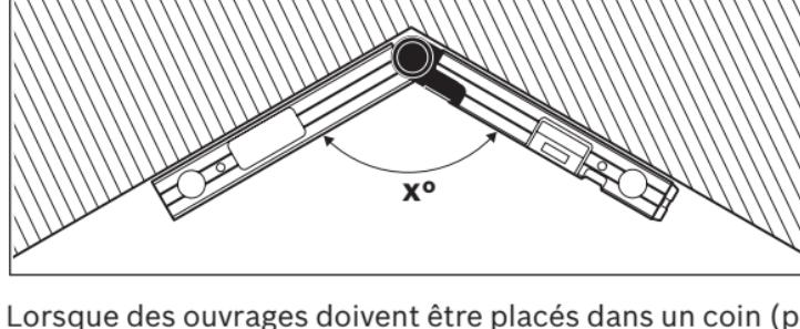
Lorsque des ouvrages doivent être placés dans un coin (p. ex., dans le cas de l'eboutage pour un plancher), mesurez l'angle de coin  $x^\circ$  en appliquant le pied pliant et le pied de la base. Pour des angles donnés (p. ex., des cadres pour tableaux), ouvrez le pied pliant et le pied de la base jusqu'à ce que l'angle désiré soit indiqué sur l'affichage.
