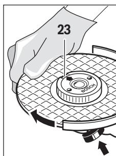
Pressionar a tecla de bloqueio do eixo **1** para imobilizar o eixo de retificação. Girar o disco abrasivo fortemente no sentido horário para apertar a porca de aperto rápido.
