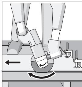
A ferramenta elétrica deve sempre ser conduzida no sentido contrário da rotação. Caso contrário há perigo de que seja arremessada para fora do corte de forma **descontrolada**.
