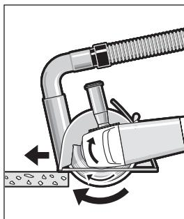
Ligar a ferramenta elétrica e colocá-la com a parte dianteira do guia paralelo sobre a peça a ser trabalhada. Empurrar a ferramenta elétrica com avanço moderado, adequado ao material a ser trabalhado. Para cortar materiais especialmente
