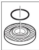
**Flange de admissão para o eixo de retificação M 14:** No flange de admissão 8 encontra-se uma peça de plástico (o-ring) em volta do colar de centragem. **Se o o-ring estiver faltando ou estiver danificado,** será imprescindível substituí-lo (número de produto 1 600 210 039), antes de montar o flange de admissão 8.
