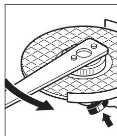
Una tuerca de fijación rápida, correctamente montada, puede aflojarse a mano girando el anillo moleteado en sentido contrario a las agujas del reloj. Jamás intente aflojar una tuerca de fijación rápida agarrotada con unas tenazas; utilice
