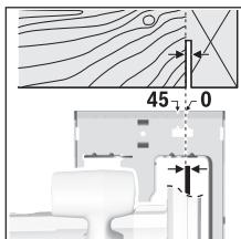
La marca de posición **0° 9** indica la posición de la hoja de sierra al efectuar cortes perpendiculares. La marca de posición **45° 8** indica la posición de la hoja de sierra al efectuar cortes a **45°**.
