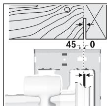
A marcação de corte de  $0^{\circ}$  **9** indica a posição da lâmina de serra para cortes perpendiculares. A marcação de corte de  $45^{\circ}$  **8** indica a posição da lâmina de corte para cortes de  $45^{\circ}$ .
