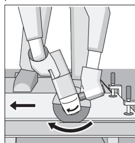
A ferramenta elétrica deve sempre ser conduzida no sentido contrário da rotação. Caso contrário há perigo de que seja arremessada para fora do corte de forma descontrolada. Para o cortar perfis e tubos quadrados, deve-se começar pela menor seção transversal.
