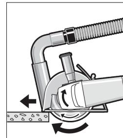
Conecte la herramienta eléctrica y asiente la parte anterior del soporte guía sobre la pieza. Desplace la herramienta eléctrica con un avance moderado adecuado al tipo de material a trabajar. Al tronzar materiales especialmente duros como, p. ej. hormigón con un alto contenido de áridos, es posible
