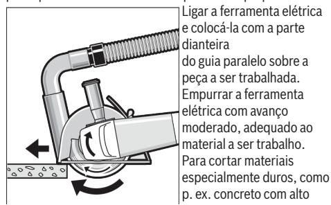
Ligar a ferramenta elétrica e colocá-la com a parte dianteira do guia paralelo sobre a peça a ser trabalhada. Empurrar a ferramenta elétrica com avanço moderado, adequado ao material a ser trabalhado. Para cortar materiais especialmente duros, como p. ex. concreto com alto
