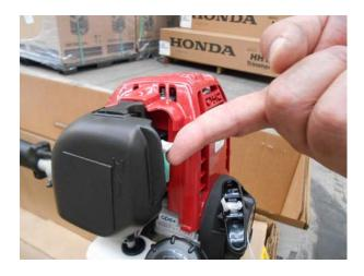
2. Aplique bombeo a la perilla que se encuentra en el carburador para cargar a este con el combustible hasta que usted observe que tiene el suficiente líquido.
