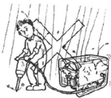
No utilice el generador en condiciones de humedad (lluvia, nieve)
