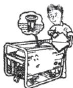
4. Vuelva a instalar el tapón del depósito de combustible
