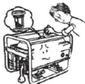
3. Rellene hasta el anclaje del filtro del combustible
