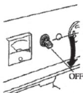
2. Gire el interruptor de arranque del generador a la posición "Off" (desactivado)
