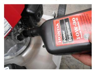
3. Una vez colocado el aceite y puesto a nivel, la bayoneta debe marcar aceite hasta la parte superior de la sección corrugada que esta tiene.
