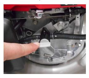
Presione el manillar del embrague para que el retráctil pueda ser utilizado ya que si usted no activa el manillar, no podrá tirar del retractil.
