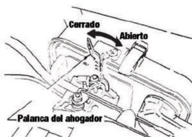
4. Sostenga la empuñadura de arranque, y jale hasta que sienta resistencia. Después jale fuerte y rápido. Regrese la empuñadura a su posición original antes de soltarla.
