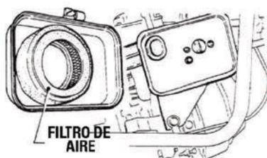
El filtro de aire ubicado del lado del motor, se ensucia mucho, por lo tanto, sumérgalo en una mezcla de 3 partes de gasolina y 1 parte de aceite. Posteriormente apriete el elemento filtro de aire (esponja) y sacuda bien el interior del filtro secundario antes de reinstalarlo.
