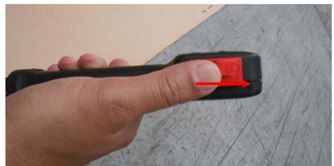
4. Tire ligeramente la empuñadura de la polea hasta sentir resistencia mientras sujeta el mango; a continuación tire con fuerza hacia fuera como se muestra.
