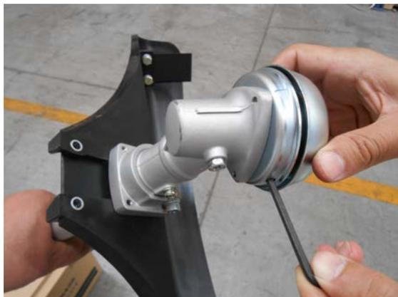
2. Gire el cabezal hasta encontrar el orificio de bloqueo del eje de transmisión para apretar o aflojar el accesorio que se vaya a utilizar según convenga.
