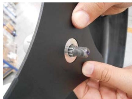
6. Coloque la placa de guía estriada.
