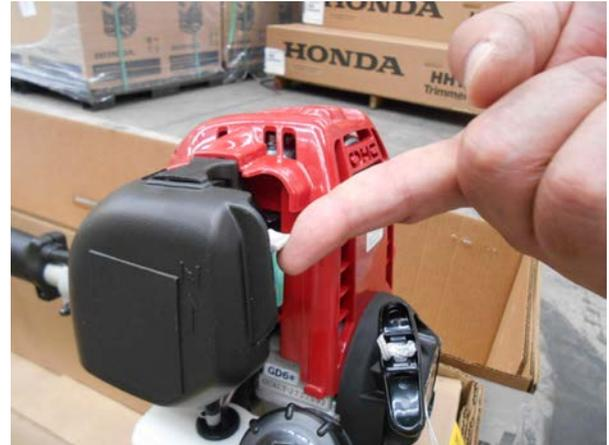
2. Aplique bombeo a la perilla que se encuentra en el carburador para cargar a este con el combustible hasta que usted observe que tiene el suficiente líquido.
