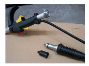
2. Afloje el perno de fijación de la articulación.
