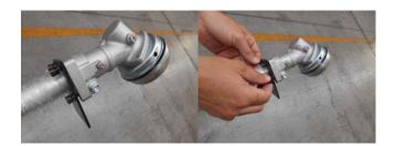
2. Remueva la lámina de metal y coloque la pantalla protectora.
