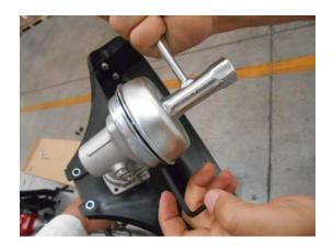
4. Retire la tuerca y la cubierta del cabezal.
