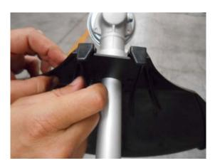
4. Apriete los tornillos, utilizando la herramienta que estaba dentro del paquete de armado de la orilladora.
