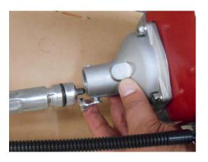
3. Posteriormente introduzca la articulación dentro del orificio hasta que esta quede insertada completamente.
