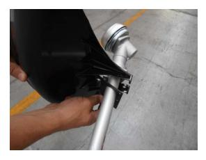
3. Coloque la lámina metálica y los tornillos para sujetarla la pantalla protectora.
