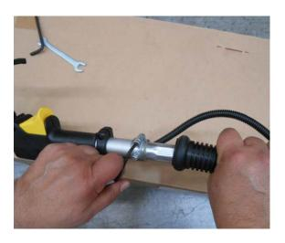
Tape los pernos con la cubierta de caucho a fin de que estos no se observen, esto evitara que estos le agredan en algún movimiento brusco.
