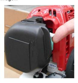
Aplique bombeo a la perilla que se encuentra en el carburador para cargar a este con el combustible hasta que usted observe que tiene el suficiente líquido.
