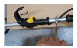
Posteriormente apriete el perno con cabeza hexagonal para que quede perfectamente asegurada y ensamblada la articulación.
