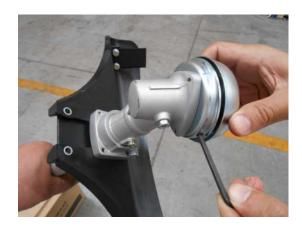
Gire el cabezal hasta encontrar el orificio de bloqueo del eje de transmisión para apretar o aflojar el accesorio que se vaya a utiliza según convenga.
