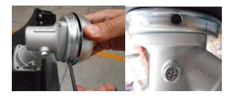
3. Una vez bloqueado el eje de transmisión, utilice la herramienta para retirar la tuerca de sujeción de este.
